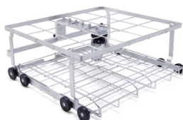
A 202 dolny wózek wsadowy pusty na 4 tace sterylizacyjne DIN umieszczone na 2 poziomach, wbudowane ramię natryskowe możliwość podłączenia 6 sztuk narzędzi rurowych za pomocą złącza typu LuerLock 1 sztuka
